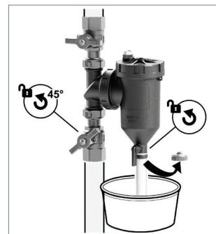
4. Apertura della valvola di intercettazione a monte e lavaggio delle parti interne.
